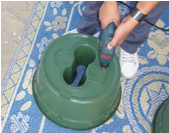
1. Om groenten te kunnen produceren moet je 2 gaten maken met elk een diameter van 4,7 mm
