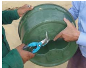
3. Plaats het lontje vanuit de binnenkant naar de buitenkant en trek hem erdoorheen met een tang
