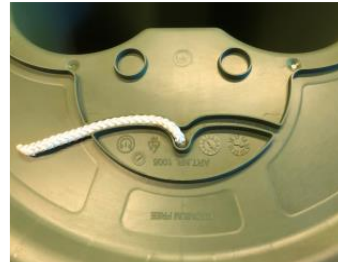
28. Elk groeiseizoen moet je de lonten eruit halen, wassen in een wasmachine bij +40°C met wasmiddel, daarna goed spoelen, en opnieuw plaatsen
